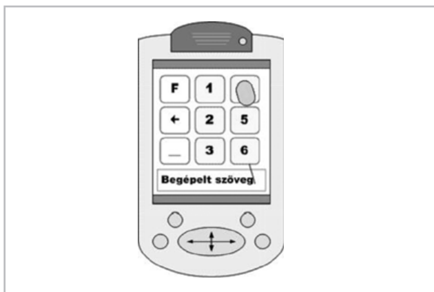
3. ábra A virtuális Braille billentyűzet sematikus rajza
