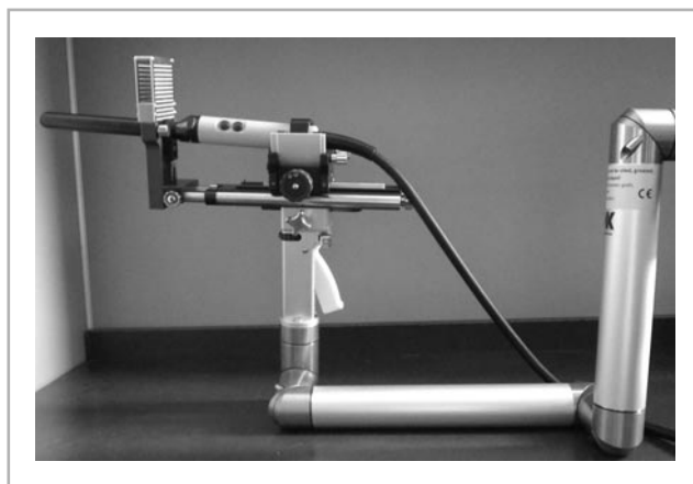
2. ábra Az ultrahanggal és a vezérlőállomással összekötésben lévő mozgatható kar. A végén látható a transzrektális ultrahangfej és a célzórács.
