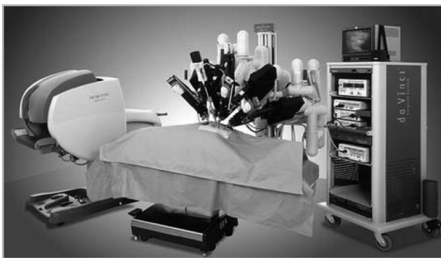
2. ábra A da Vinci komplett teleoperációval működtethető robotrendszer
