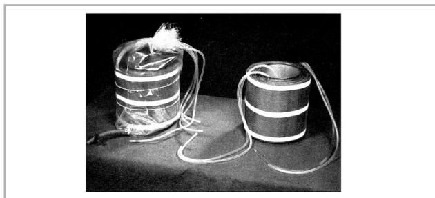
1. ábra A képen baloldalon Koloff egyszer használatos celofán membrán oxigenátora
